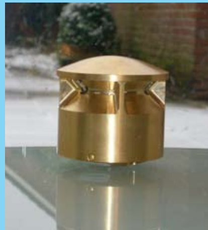
Sensor, hoogte 8 cm., ø 9 cm.
